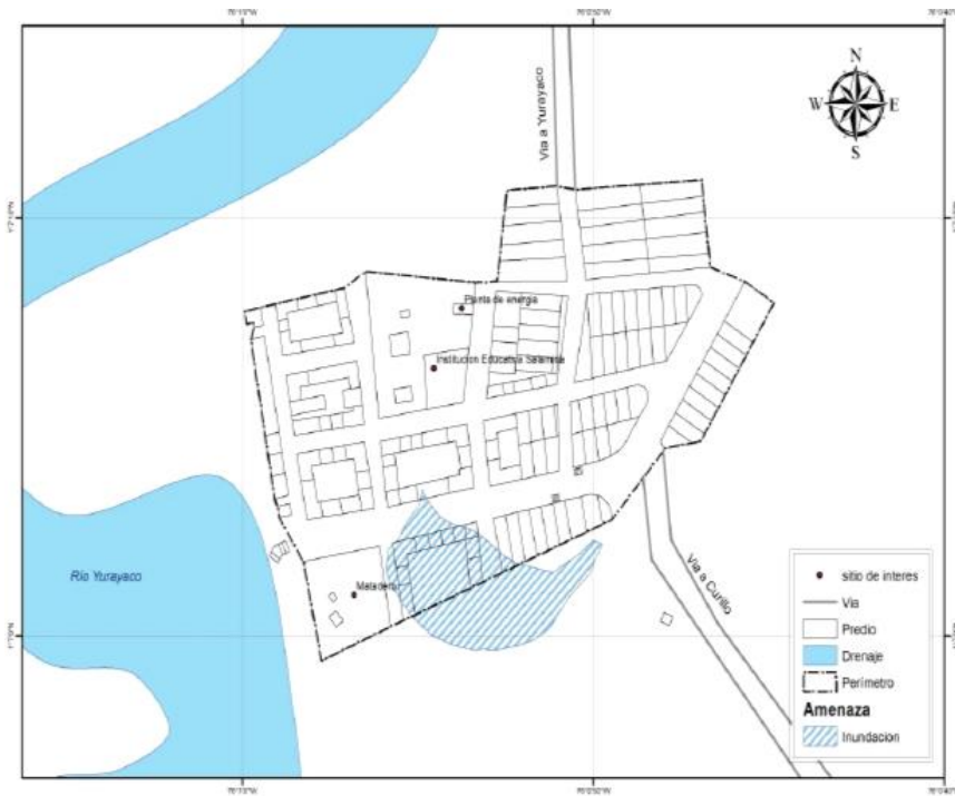
Figura 47 Zonas inundables en el centro poblado Salamina
